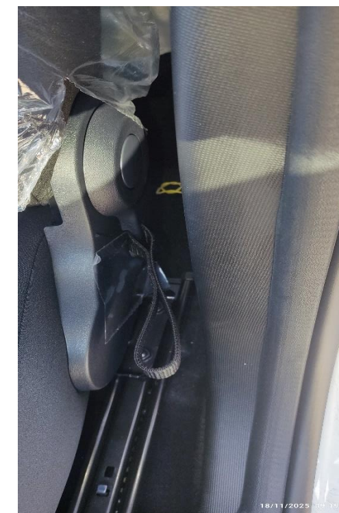
Tirante para facilitar el plegado de los asientos
