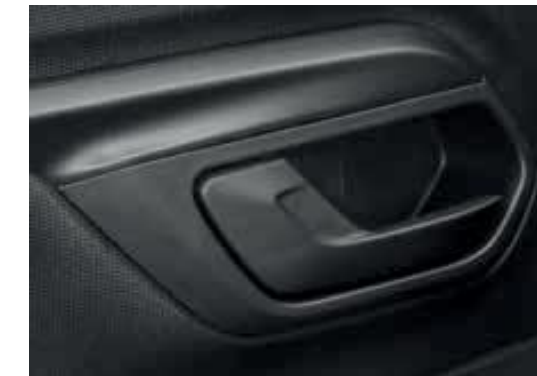
Seguro de puerta integrado en la manilla interna
